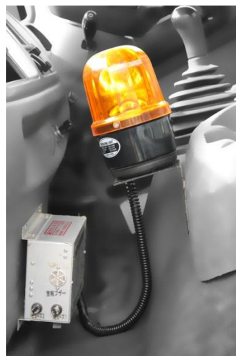
コントロールボックス、点滅灯
